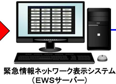
緊急情報が入ったら、放送設備を起動して放送を流したり、サイレン等を鳴らす事ができます。また、遠隔地の機器(照明のON/OFF、サイレン、放送設備の起動など)に対して、VPN等を利用する事で制御が可能になります。
