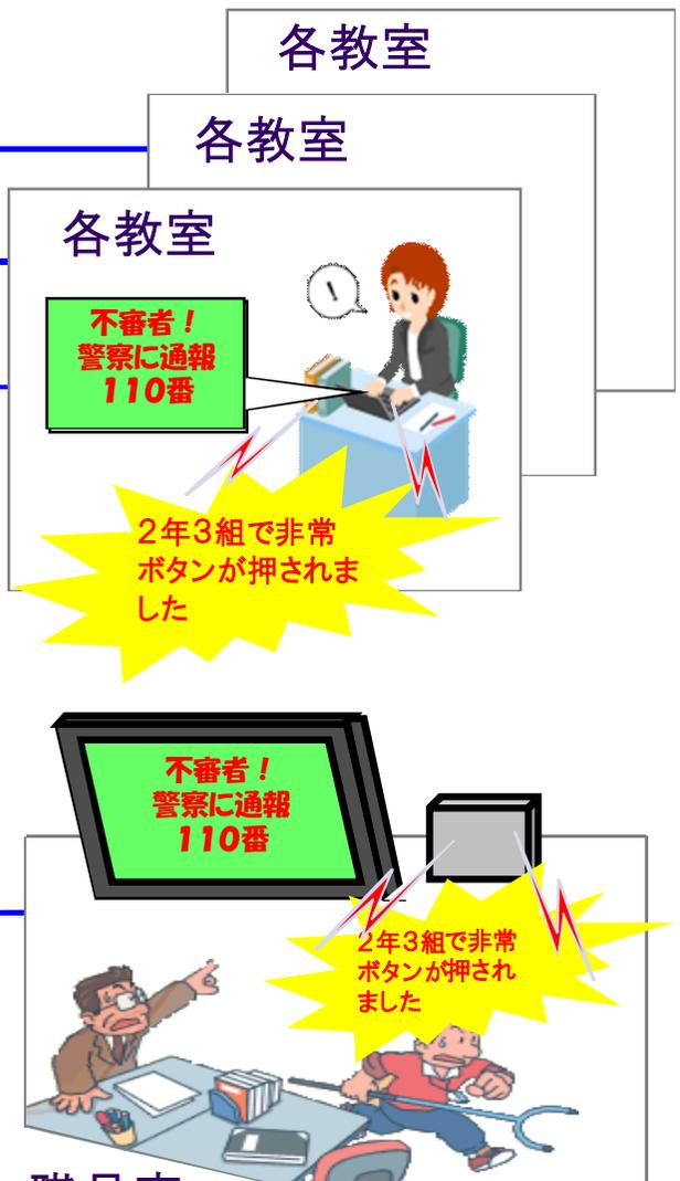
不審者を発見し非常押ボタンを押した場合、既設校内LANを經由し、教室で使っている先生のパソコンや職員室に設置した大型ディスプレイに緊急メッセージ画像を表示します。メールの自動配信もできます。
